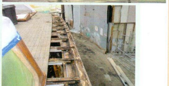
*Vanessa* wurde nach einem System gebaut, das sich „Doppeldiagonal“ nennt. Dabei laufen die äußeren 1,5-Zoll dicken Planken in eine Richtung und die inneren im 90-Grad-Winkel. Dadurch entstand ein sehr stabiler Rumpf mit über drei Zoll Dicke
