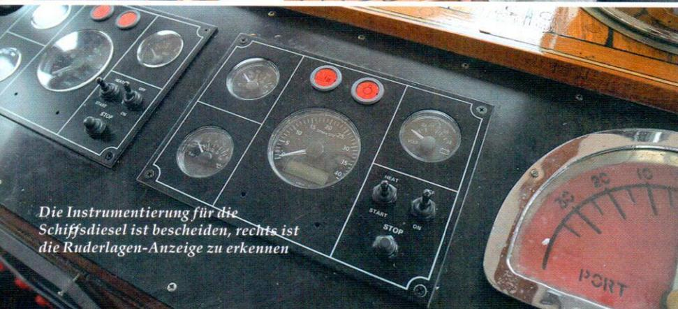
Die Instrumentierung für die Schiffsdiesel ist bescheiden, rechts ist die Ruderlagen-Anzeige zu erkennen
